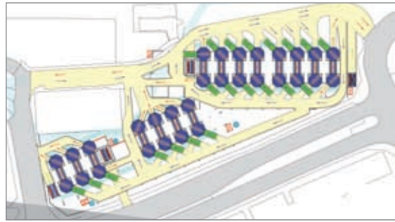
21 Transfer cabins in parking mode and 12 in departure mode 21 Übergabekabinen im Ein- und 12 im Ausparkmodus
